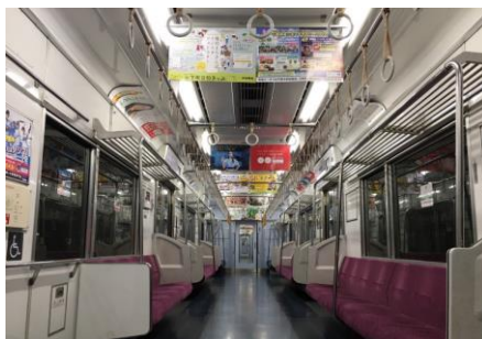
車内照明をLED化した車両
